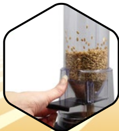
2. 将落料筒中的谷物全部倒入测定仪
