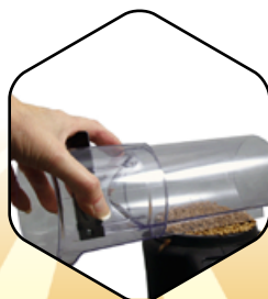
3. Araser la cellule de mesure
