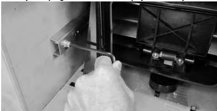
Ilustracja 6 Poluzuj śrubę z gniazdem sześciokątnym w uchwycie
