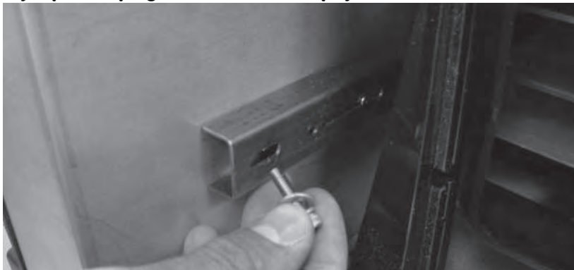
Ilustracja 7 Wykręć śrubę z gniazdem sześciokątnym
