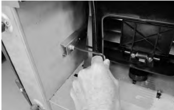
Рис. 6 Отпускание болта кронштейна с шестигранной головкой
