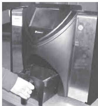
Рис. 74 Извлечение выдвижного ящика для зерна
