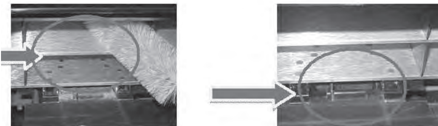
Рис. 82 Очистка поверхности вокруг ячейки, петли, дверцы уловителя, края ячейки
