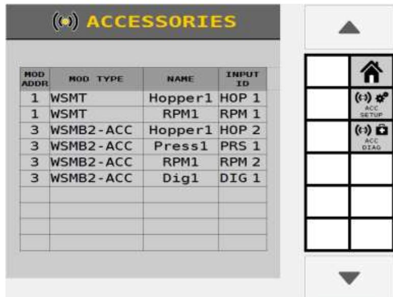
L'écran de configuration des accessoires permet de configurer les capteurs accessoires pour chaque module accessoire pris en charge. La touche programmable **MODULE SUIVANT** permet de
