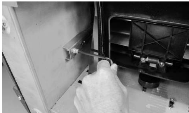
Obrázek 6 Odšroubování šroubu se šestihrannou hlavou z držáku
