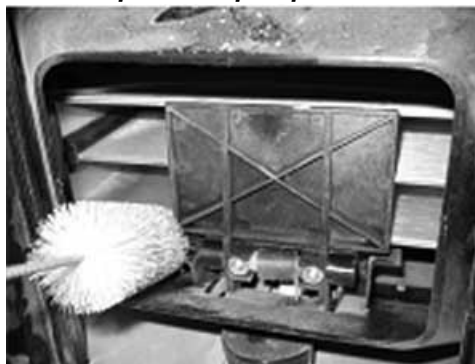
Obrázek 83 Očištění prostoru pod padacími dvířky
