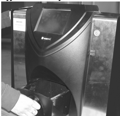
Obrázek 74 Vyjmutí zásuvky na zrna
