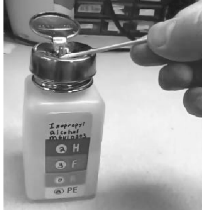
Obrázek 91 Navlhčení tyčinky v alkoholu
