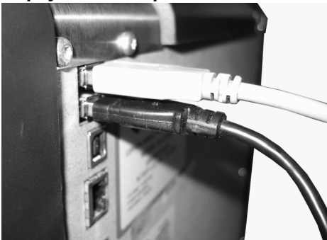
Obrázek 78 Odpojení kabelů periférií
