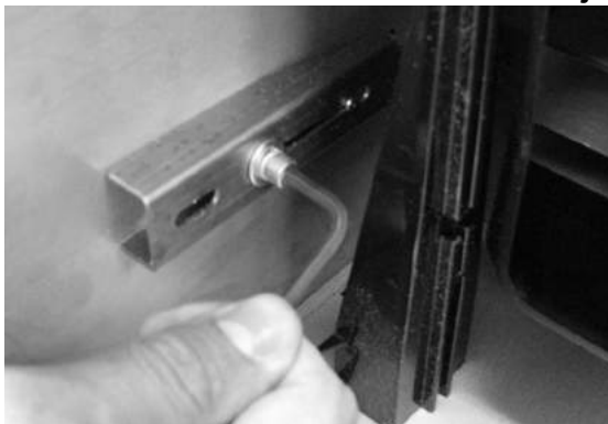
Obrázek 10 Vložení šroubu se šestihlannou hlavou a jeho utáhnutí
