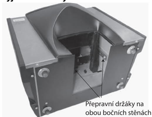
Obrázek 5 Vyjmutí zásuvky na zrna a nalezení umístění přepravních držáků
