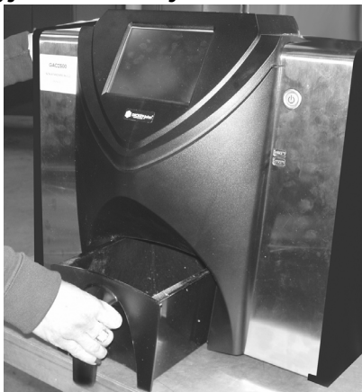
Obrázek 79 Vyjmutí zásuvky na zrna
