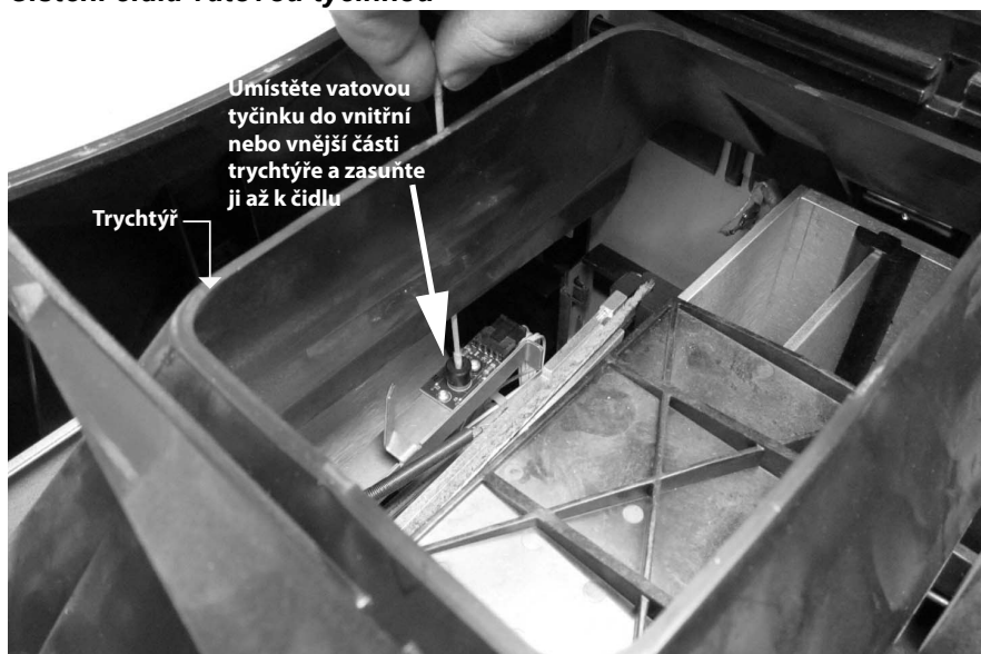
Obrázek 93 Čištění čidla vatovou tyčinkou
